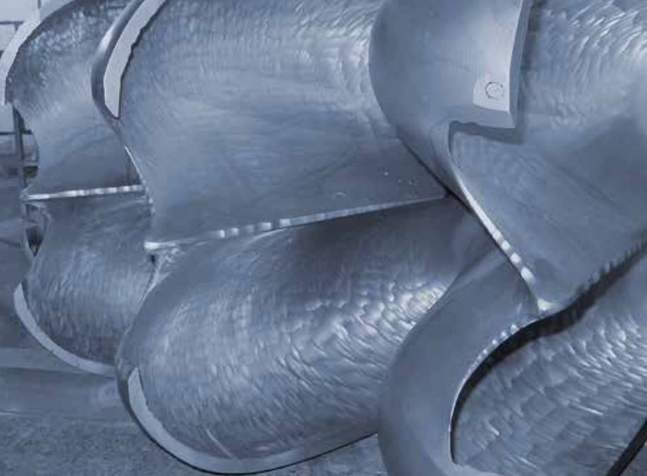
Abrasionsschäden an einem Pelton-Laufrad auf Grund von hohem Schwebstoffgehalt im Triebwasser.
