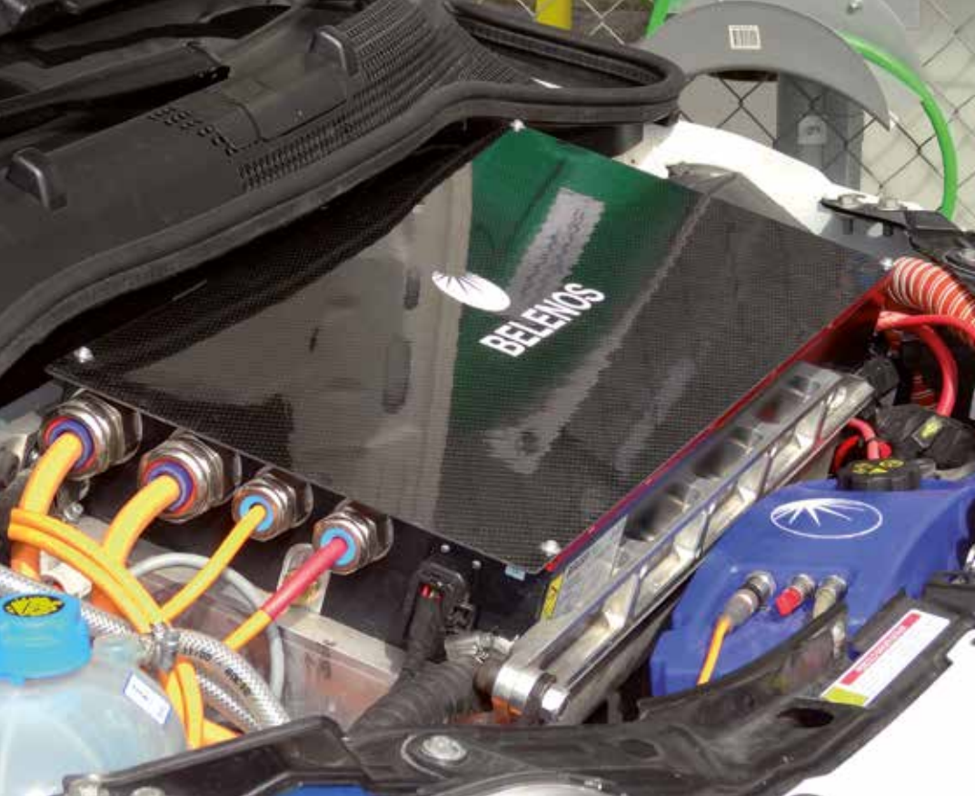
Die Integration eines Brennstoffzellensystems als «Range-Extender» in einem Kleinfahrzeug stellt sowohl mechanisch als auch elektrisch eine grosse Herausforderung dar.
