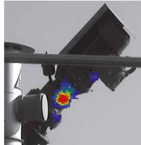
Gasverluste an einem Rührwerk einer Biogasanlage (Rot/blau = hohe/tiefe Methankonzentrationen; links: vor dem Einfetten, rechts: nach dem Einfetten).
