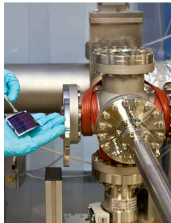
Die Empa gehört weltweit zu den führenden Labors im Bereich effizienter CIGS-Dünnschichtsolarzellen. Seit 1999 konnte der Wirkungsgrad in verschiedenen Entwicklungsschritten von rund 13 % auf über 20 % angehoben werden, wobei jeder Schritt einen weltweiten Rekordwert darstellt.
